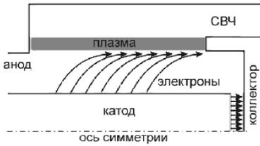
Схема прибора показана на рисунке. Система аксиально-симметрична, внешнее магнитное поле отсутствует, на катод подается импульс напряжения 500 кВ, полный ток с катода ~25 кА. Электроны, эмитированные с торца катода на коллектор с током ~20 кА, создают азимутальное магнитное поле. Электроны с боковой поверхности катода движутся в скрещенных полях: азимутальном магнитном и радиальном электрическом частично вдоль
