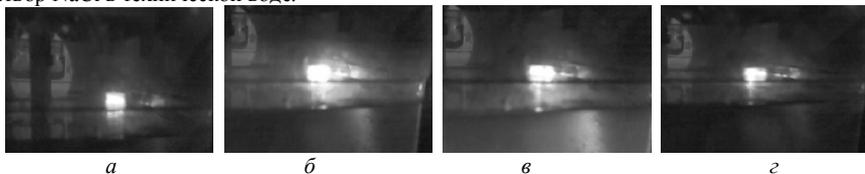
Рис. 1. Высокочастотный емкостной разряд в аргоне между медной пластиной и электролитом из насыщенного раствора NaCl в технической воде при  $l = 6$  мм:  $a - P = 10^5$  Па;  $b, v, z - P = 10^4$  Па
