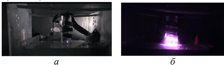
Рис. 1. Горение ВЧ-индукционного разряда со струей 3% раствора. При дальнейшем повышении происходит пробой между индуктором/кольцом, что приводит к их расплавлению.  $(\text{NH}_4)_2\text{SO}_4$  в разрядной трубке: а)  $U_{\text{разр}}=0,38$  кВ,  $I_{\text{разр}}=0,16$  А; б)  $U_{\text{разр}}=0,68$  кВ,  $I_{\text{разр}}=0,34$  А.
