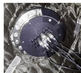
Рис.1 Расположение Si и CdTe детекторов для регистрации быстропеременных возмущений рентгеновского излучения в предварительных экспериментах на токамаке Т-15МД
