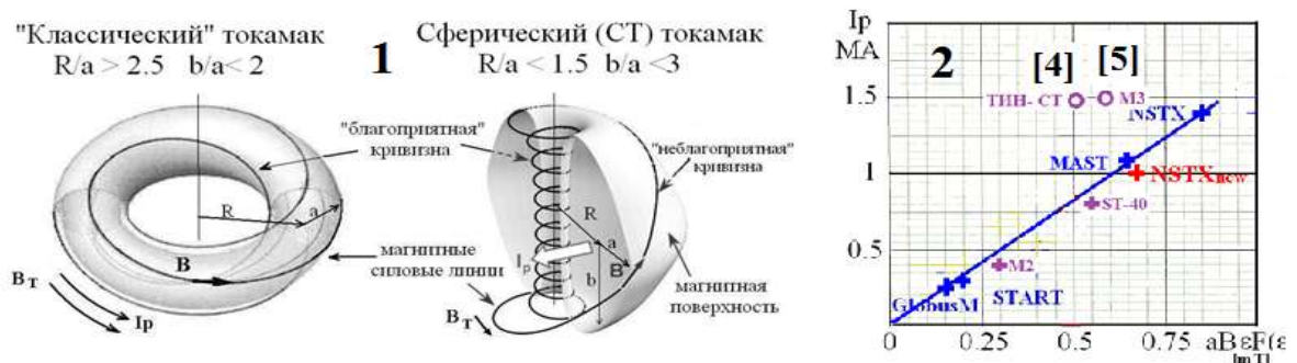
1 Магнитные конфигурации токамака и СТ. 2-максимальные токи J_p реально полученные на разных СТ и (кружки) рассчитанные в предположении q(a)=3
