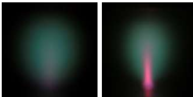
Рисунок 1. Контракция разряда при увеличении давления от 345 до 355 Торр.
