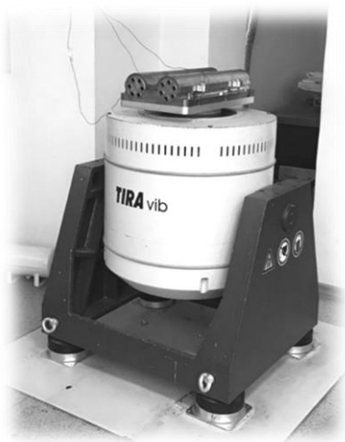
Рисунок 1 – Прототип модуля ДМНП на вибростенде
